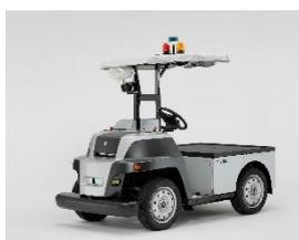
「eve auto」は、工場や物流施設などの敷地内の建屋間など、屋外で自動搬送を導入できるパッケージ化されたソリューションです。高い走破性を持つEVカートと、最先端の自動運転技術を組み合わせた無人搬送車両を中心に、アフターサポートや自動運転保険など、運用に必要な要素をすべてまとめてサブスクリプションサービスとしてご提供しています。これまで工場や倉庫の屋内で普及しているAGVには対応できなかった屋外の自動搬送を実現します。
